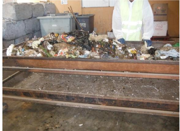
*table de tri et de criblage à 20 mm et 8mm*
