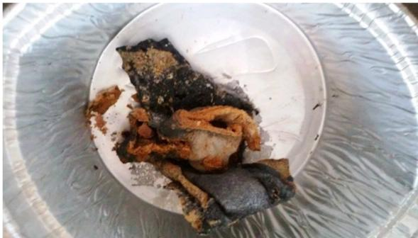
Figure 10 : Echantillon de type composite en sortie de four
