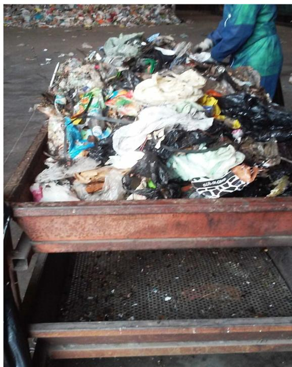
Figure 1 : Table de tri à cycléa
