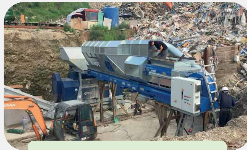
Chaîne ECOHOG Windshifter de production de CSR à partir de déchets déstockés (Corée du Sud)
